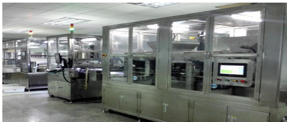
图 2 公司的机器视觉、深度学习的应用，槟榔点卤自动化生产线
